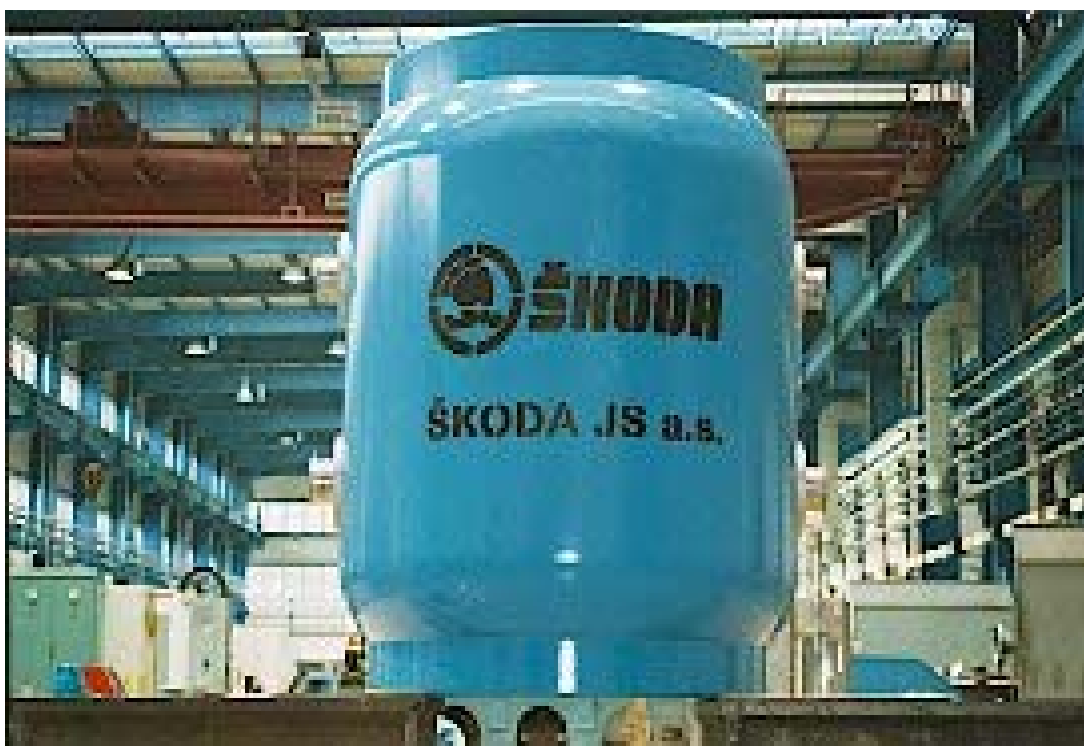
3.1. attēls. Lietotās kodoldegvielas transporta un uzglabāšanas konteinners VPVR
