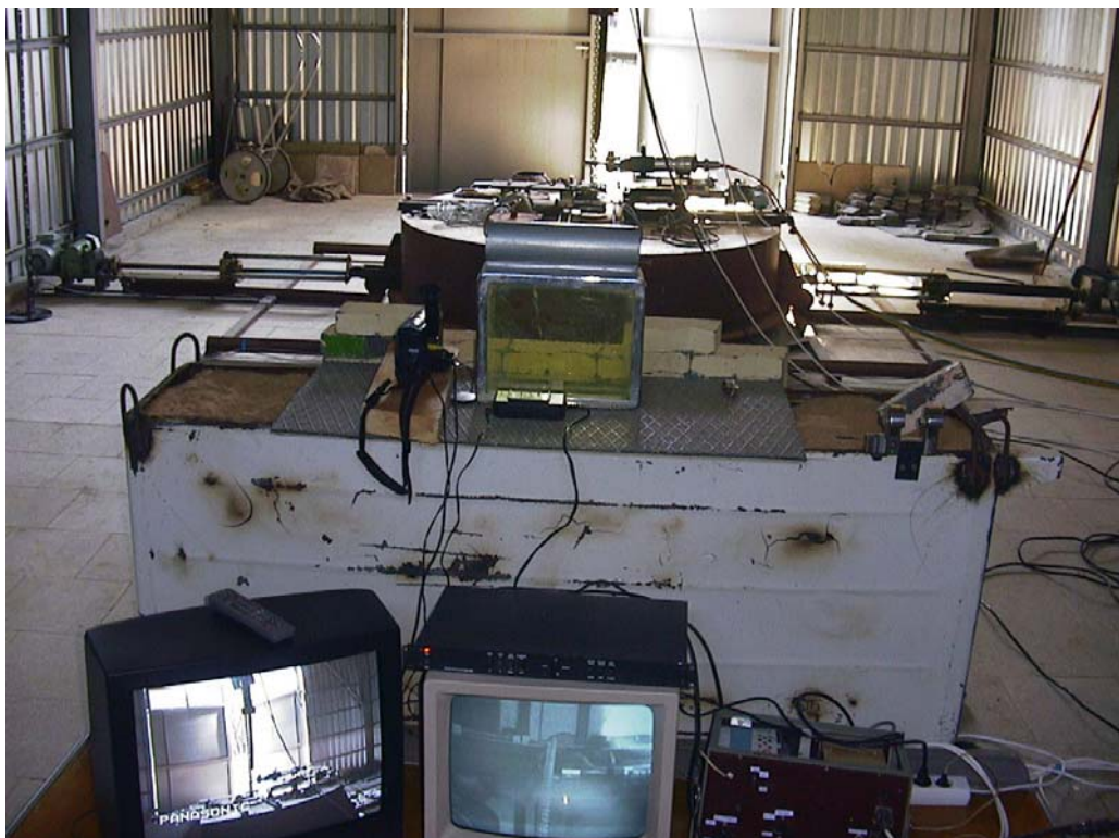
3.5. attēls. Radioaktīvo atkritumu pagaidu glabātavas iztīrīšana, izmantojot tīrīšanas tehniku
