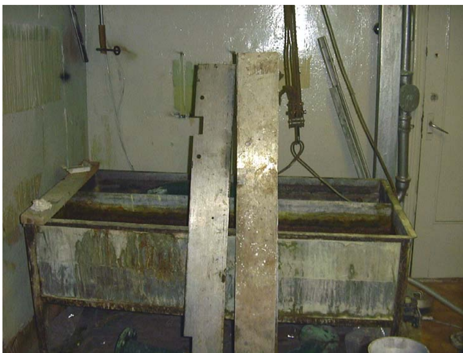
4.3. attēls. Demontēto detaļu kodināšanas vanna, izmantojot skābeņskābes šķīdumu
