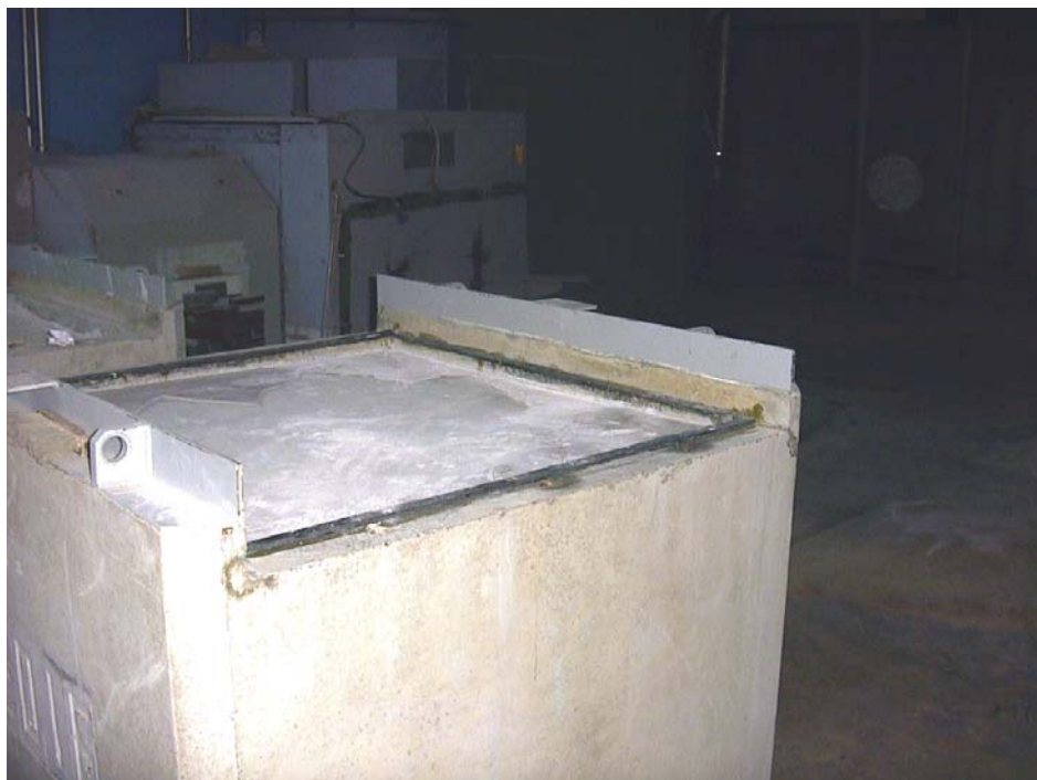
4.6. attēls. Konteiners ar iecementētiem radioaktīvajiem atkritumiem pirms hermetizēšanas
