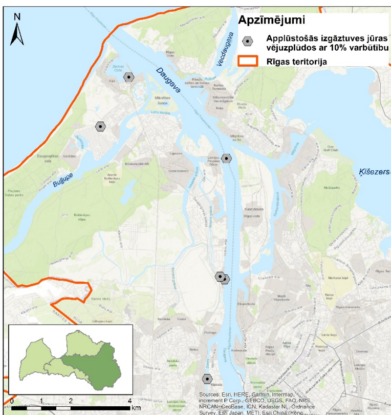
4. attēls. Applūstošās izgāztuves jūras vējuzplūdos ar 10% pārsniegšanas varbūtību
