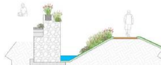
Kanāls ar gabiona atbalsta sienu
