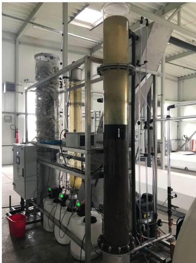
12. attēls. Testēšanas iekārta, kas izveidota BEST (Better Efficiency for Industrial Sewage Treatment) projekta ietvaros, ko finansē INTERREG Baltijas jūras reģiona programma. Attēlā redzamā konfigurācija sastāv no smilšu filtra, kas apvienots ar GAO.
