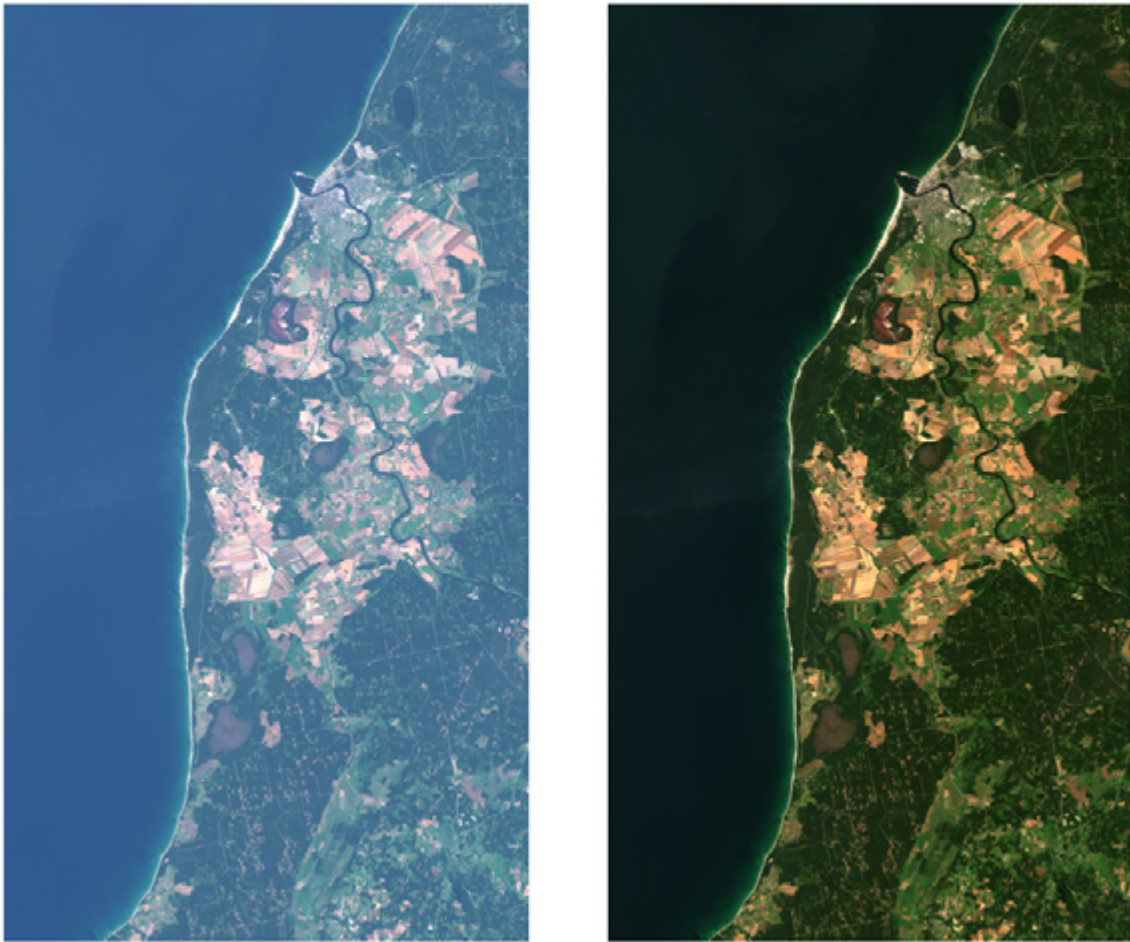
7. attēls. 2020. gada 15. augusta Sentinel-2 satelīta uzņēmums redzamajā spektrā 11. analīzes poligonā pirms (kreisā puse) un pēc (labā puse) atmosfēras korekcijas pielietošanas.
