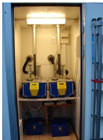
3.4.3.3. attēls. Stacija Rīga-Kronvalda bulvāris, SM200 PM 10 un PM 2.5 mēraparatūra konteinerā
