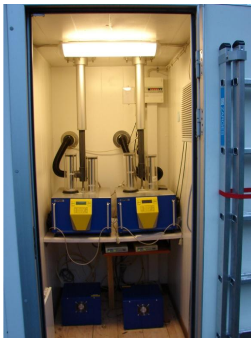
4.3.3.3. attēls. Stacija Rīga-Kronvalda bulvāris, SM200 PM 10 un PM 2.5 mēraparatūra konteinerā
